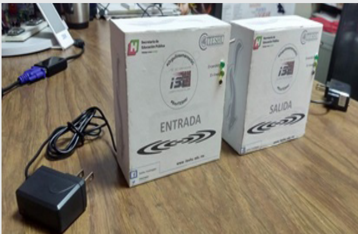
Figura 15: Fotografía de los prototipos de Entrada y Salida ya con cajas de protección (Construcción Propia)
